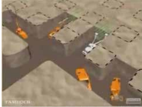
Şekil 2.2. Yeraltı metotlarından oda topuk metodu [6]
